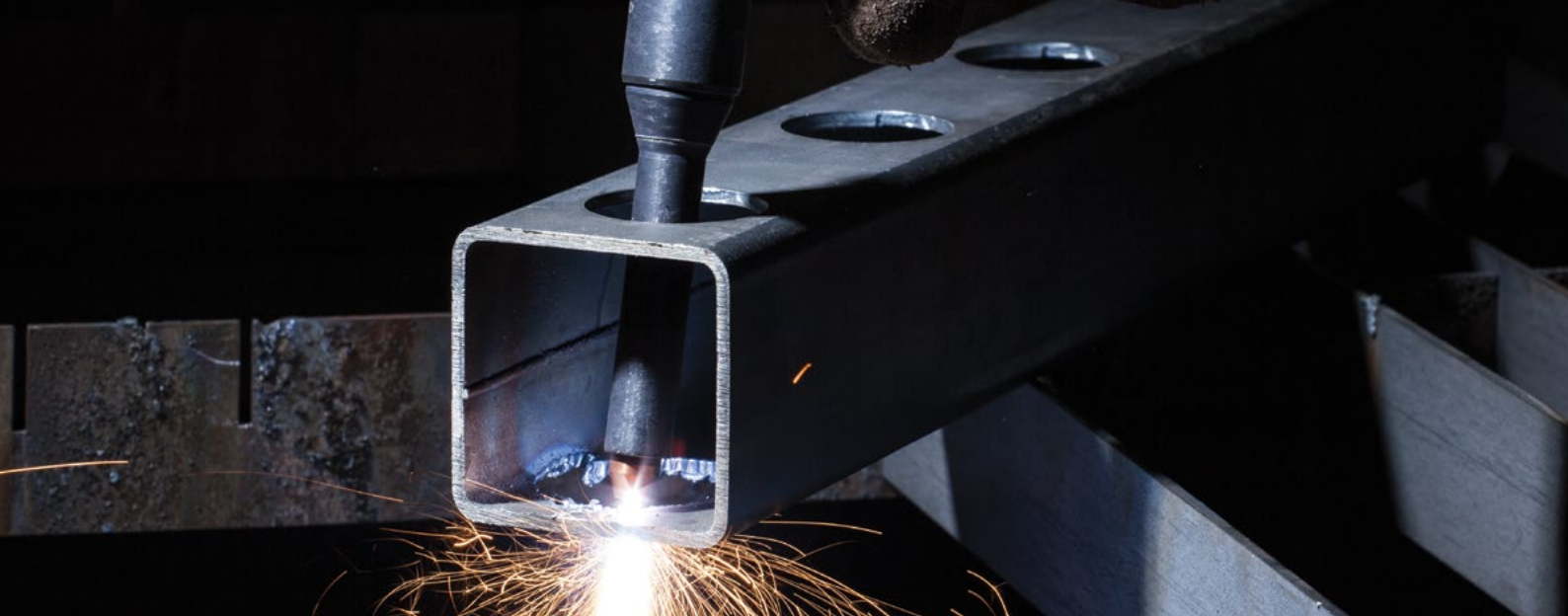
HyAccess 消耗部品 標準の Powermax 消耗部品 よりも約 76 mm 長いリーチ
